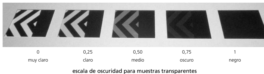
Figura 6. Variación de oscuridad para una muestra transparente (permeabilidad 1), con un cierto grado de difusividad (en este caso, difusividad 0).
