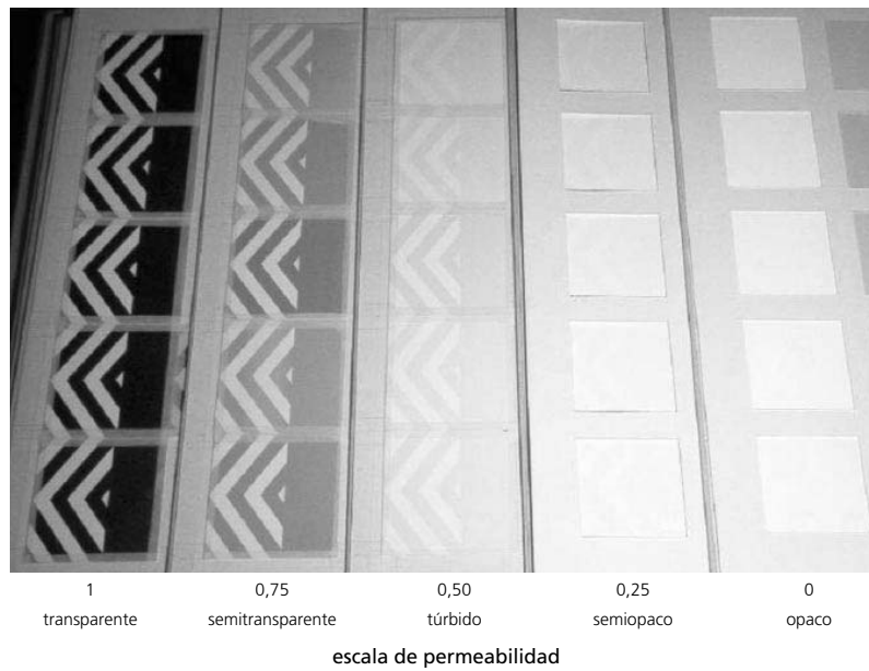
Figura 5. Cinco pasos de permeabilidad. Aunque no puede apreciarse en la foto, la variación de difusividad se da en vertical para cada paso. Con el agregado de la variación de oscuridad, cada una de estas escalas da origen a su vez a una página completa como la de la Figura 4.
