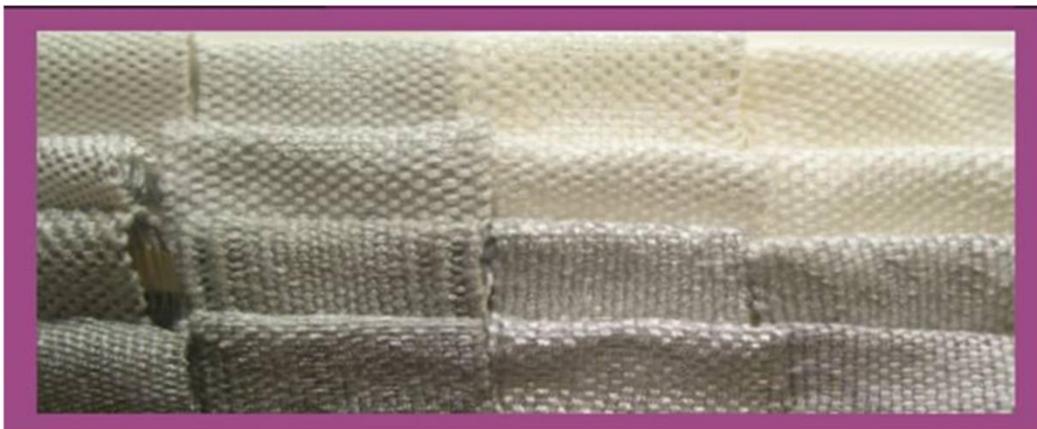
Figura 4: Las 16 muestras de tejido de estructura simple, tafetán, generadas con los 4 hilados de mínima absorción y variación en la difusividad, que se encuentra en el mercado local.
