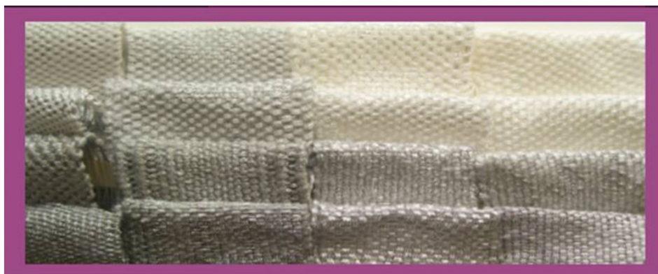
Figura 5: Las 16 muestras de tejido de estructura simple, tafetán, generadas con los 4 hilados de mínima absorción y variación en la difusividad, que se encuentra en el mercado local.
