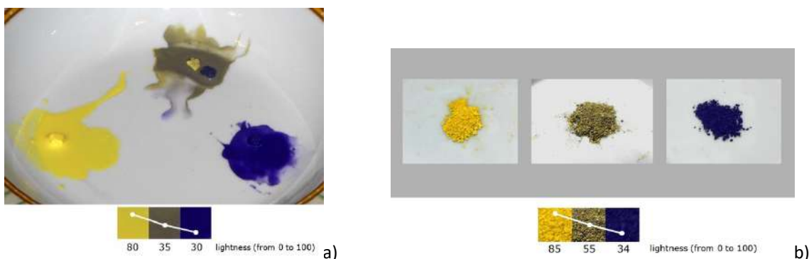
Рисунок 8: Смешивание пигментов как результат партитивного цветообразования; конечный зеленый цвет является промежуточным по светлоте. а) Смешивание пигментов в пасту (с небольшим содержанием воды); б) смешивание пигментов в форме порошка
